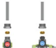
Вставьте трубки смесителя 10 мм в корпус коллектора и шарового крана до упора, вместо втулки. Закрутите 3D футорку для герметизации соединения.
